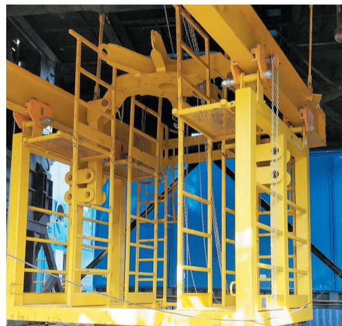
Механизм заведения для монтажа и демонтажа противовыбросового оборудования на скважине № 292 Куюмбинского месторождения
