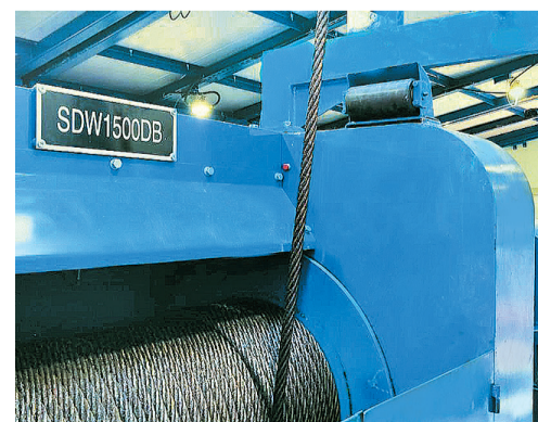
Электрическая буровая лебедка SDW1500DB на скважине № 292 Куюмбинского месторождения
